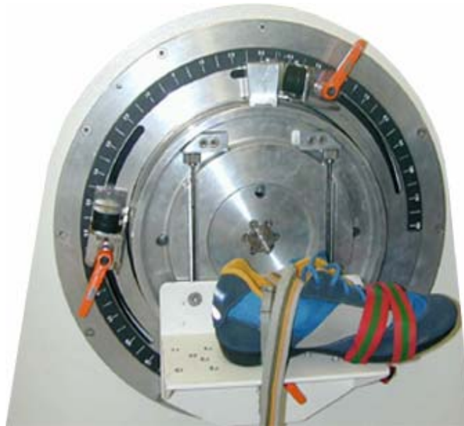
Fig. 4 : Face avant de la tête motrice. Le pédalier est fixé sur un plateau solidaire du rotor du moteur. Le système de contention de la cheville, une chaussure à semelle rigide, est fixé sur ce pédalier.
