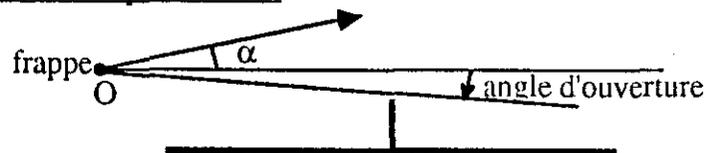
L'angle vertical de vitesse de la balle est en général différent de l'angle d'ouverture vertical.
